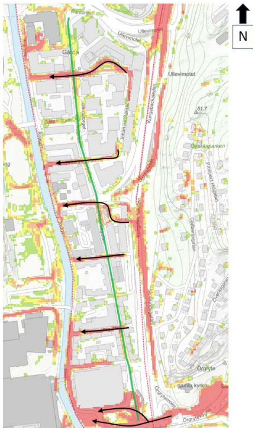
Figur 24. Vatten som rör sig över Fabriksgatan (grön markering) vid ett skyfall.
